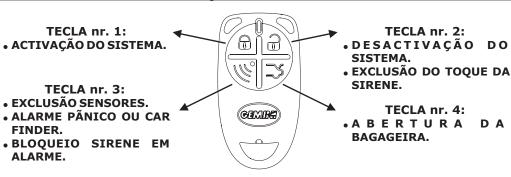
Em caso de baterias em fase de esgotamento, a cada pressão de uma tecla do rádio controlo (comando a distância), o LED se ilumina de modo intermitente.
