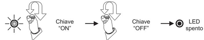
Trascorsi 4 sec., il LED inizierà una nuova sequenza di 9 lampeggi. Ripetere l'operazione sopra descritta per inserire la 2ª cifra.
