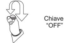
Trascorsi 4 sec., il LED inizierà una serie di 9 lampeggi. Ruotare la chiave in posizione "ON" e "OFF" quando si intende memorizzare la 1ª cifra del nuovo codice PIN.
