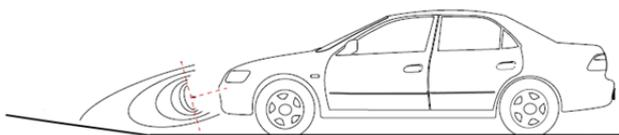
Sensori eccessivamente inclinati verso il basso => falsi allarmi dovuti alla lettura delle asperità della strada.
