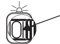
Presionar una sola vez el pulsador del LED para activar la función. Una señal acústica con tonalidad aguda confirma la operación.
