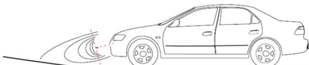
Capteurs excessivement inclinés vers le bas => fausses alertes dues à la lecture des aspérités du terrain.
