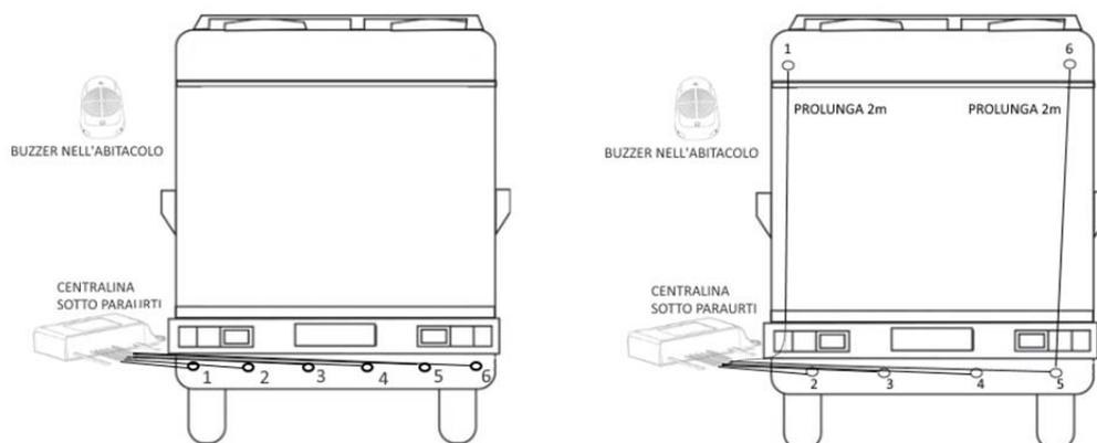
7. Posizionare i fermacavi adesivi in dotazione lungo il paraurti, inserire le fascette e fissare i cavi in posizione. Radunare eventuali cavi in eccesso.
