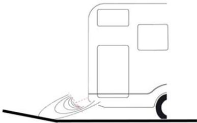
Sensori eccessivamente inclinati verso il basso => falsi allarmi dovuti alla lettura delle asperità della strada.
