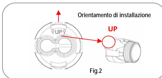
6. Collegare i sensori ai cavi provenienti dalla centralina come indicato nella figura sottostante, a seconda della disposizione preferita. Le presenti istruzioni di installazione valgono per i veicoli con guida a sinistra. I vari passaggi del montaggio sui veicoli con guida a destra sono eseguiti sul lato opposto e/o all'inverso.
