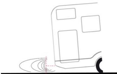
Sensori installati correttamente ma il camper è sovraccarico => la variazione di assetto altera la lettura dei sensori.
