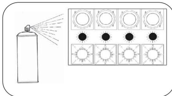
4. Chudere la dima a scatola. Verniciare i sensori e gli adattatori e assicurarsi della completa essiccazione della vernice prima di assemblare i componenti.
