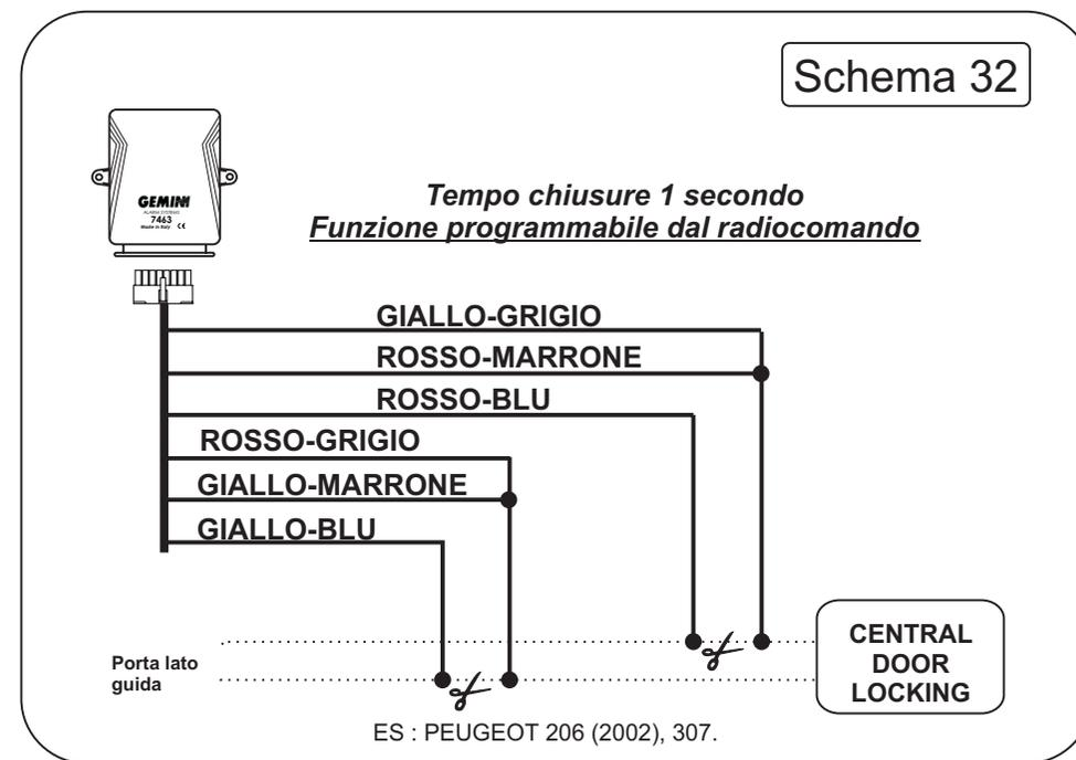
Per vetture dotate di chiusure centralizzate elettriche a comando negativo o positivo.
